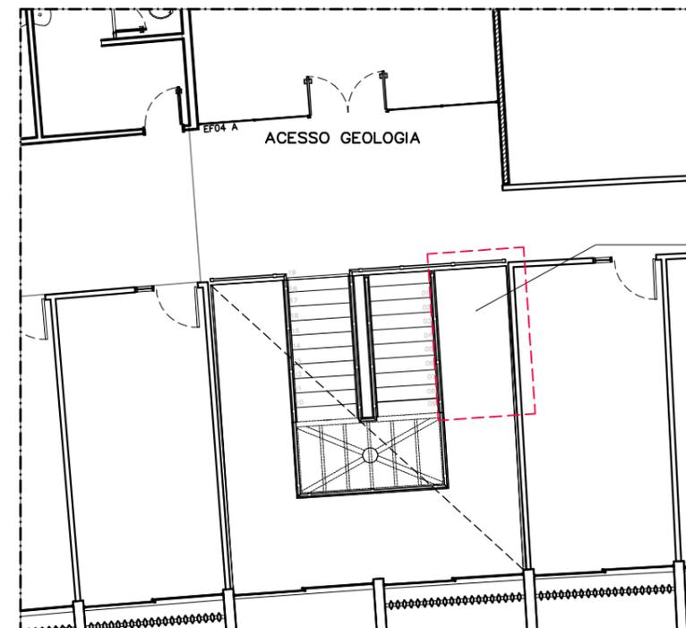
LOCAL DE INSTALAÇÃO DE PLATAFORMA VERTICAL CONECTANDO PAV. TÉRREO E 1ª PAV.
