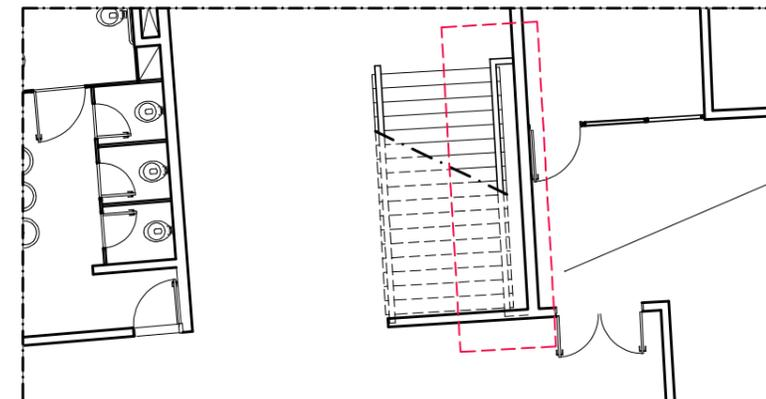
LOCAL DE INSTALAÇÃO DE PLATAFORMA INCLINADA CONECTANDO PAV. TÉRREO E SUBSOLO
