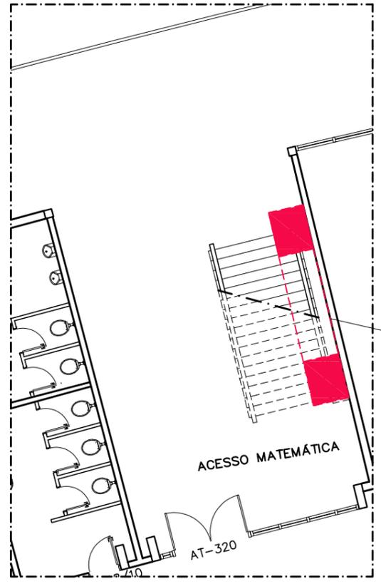
LOCAL DE INSTALAÇÃO DE PLATAFORMA INCLINADA CONECTANDO PAV. TÉRREO E SUBSOLO
